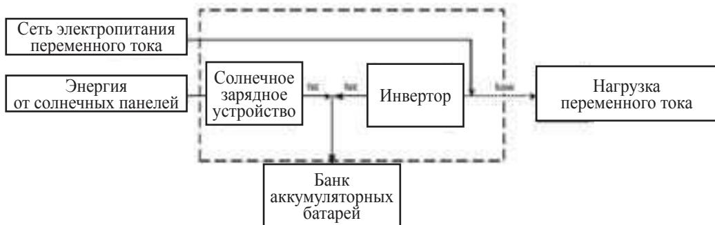
Аккумуляторная батарея заряжается одновременно от сети электропитания и от солнечного зарядного устройства. Общий зарядный ток  $I_{CHG} = I_{UC} + I_{SC}$ , при этом максимальное значение тока  $I_{CHG}$  составляет 50 А. Если выключатель питания ON/OFF (ВКЛ/ВЫКЛ) установлен в положение ON (ВКЛ), устройство подаст питание на нагрузку. Если выключатель питания ON/OFF установлен в положение OFF (ВЫКЛ), устройство не будет подавать питание на нагрузку.
