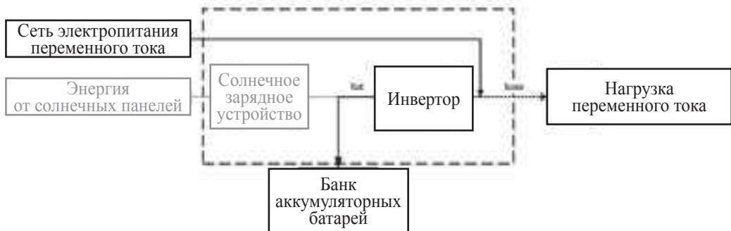
Аккумуляторная батарея заряжается от сети электропитания. Максимальное значение тока  $IUC$  составляет 30 А. Солнечное зарядное устройство не работает. Если выключатель питания ON/OFF (ВКЛ/ВЫКЛ) установлен в положение ON (ВКЛ), устройство подаст питание на нагрузку. Если выключатель питания ON/OFF установлен в положение OFF (ВЫКЛ), устройство не будет подавать питание на нагрузку.
